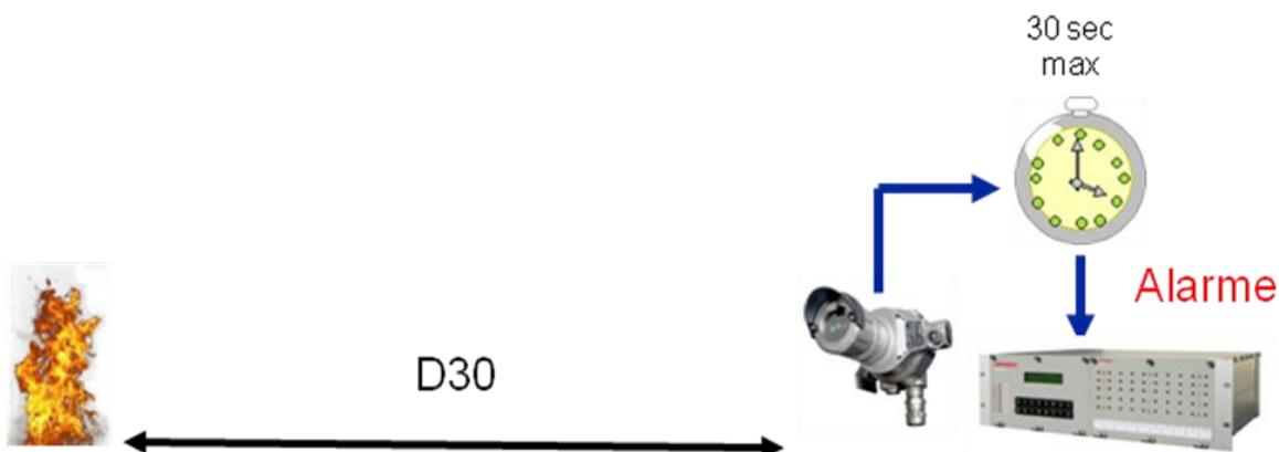
figure 3 : détermination de la distance de détection
